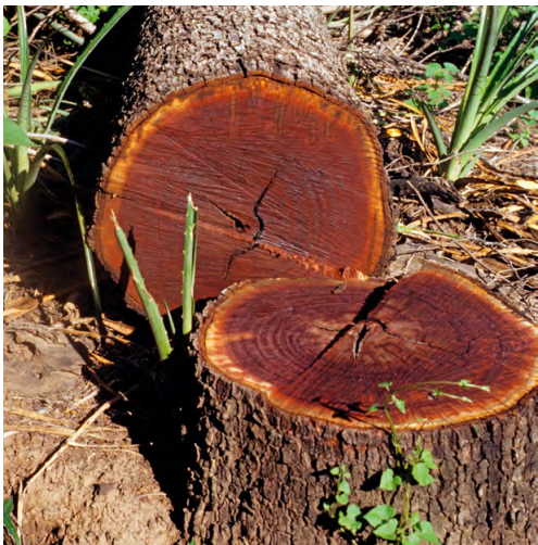
Bongossi: Das Holz stammt aus Afrika, meist aus Kamerun. Seine hohe Dichte macht es schwer und fast immun gegen Schädlinge.
