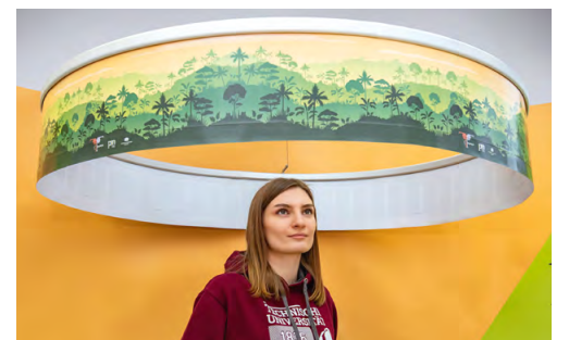
Gedruckte Lautsprecher erzeugen eine überraschende Urwald-Illusion: Die in eine Papierbahn eingebettete gedruckte Elektronik ermöglicht einen 360°-Surround-Sound.
