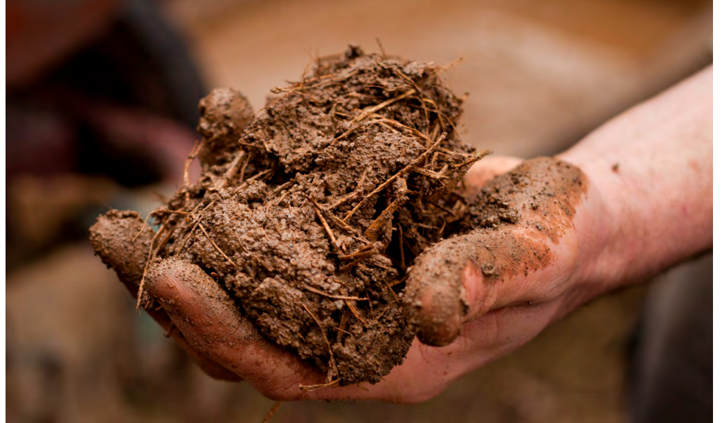
Spezieller Stoff: Lehm besteht aus Ton, Sand und feinkörnigem Sedimentgestein („Schluff“). Zur Verarbeitung muss er feucht sein. Der Fachmann weiß: Kein Lehm ist wie der andere.
